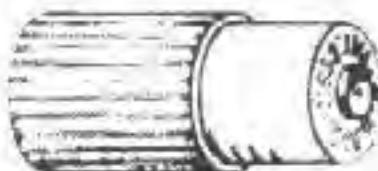
Plastični čep sa omotačem i željeznim jezgrom je jedinstven projektil koji je postavljen u čauru direktno na barutno punjenje. Pri opaljenju donji dio plastičnog čepa se širi i potpuno zaptiva cijev spriječavajući prođor barutnih gasova uz istovremeno vođenje zrna kroz cijev i čok. Prema Češkoj literaturi može se ispaljivati iz svih čokova uključivo do suženja od 1,1 mm, vrlo malo se deformiše u tijelu divljači tako da ima veliku probognost uz malo oštećenje mesa.
